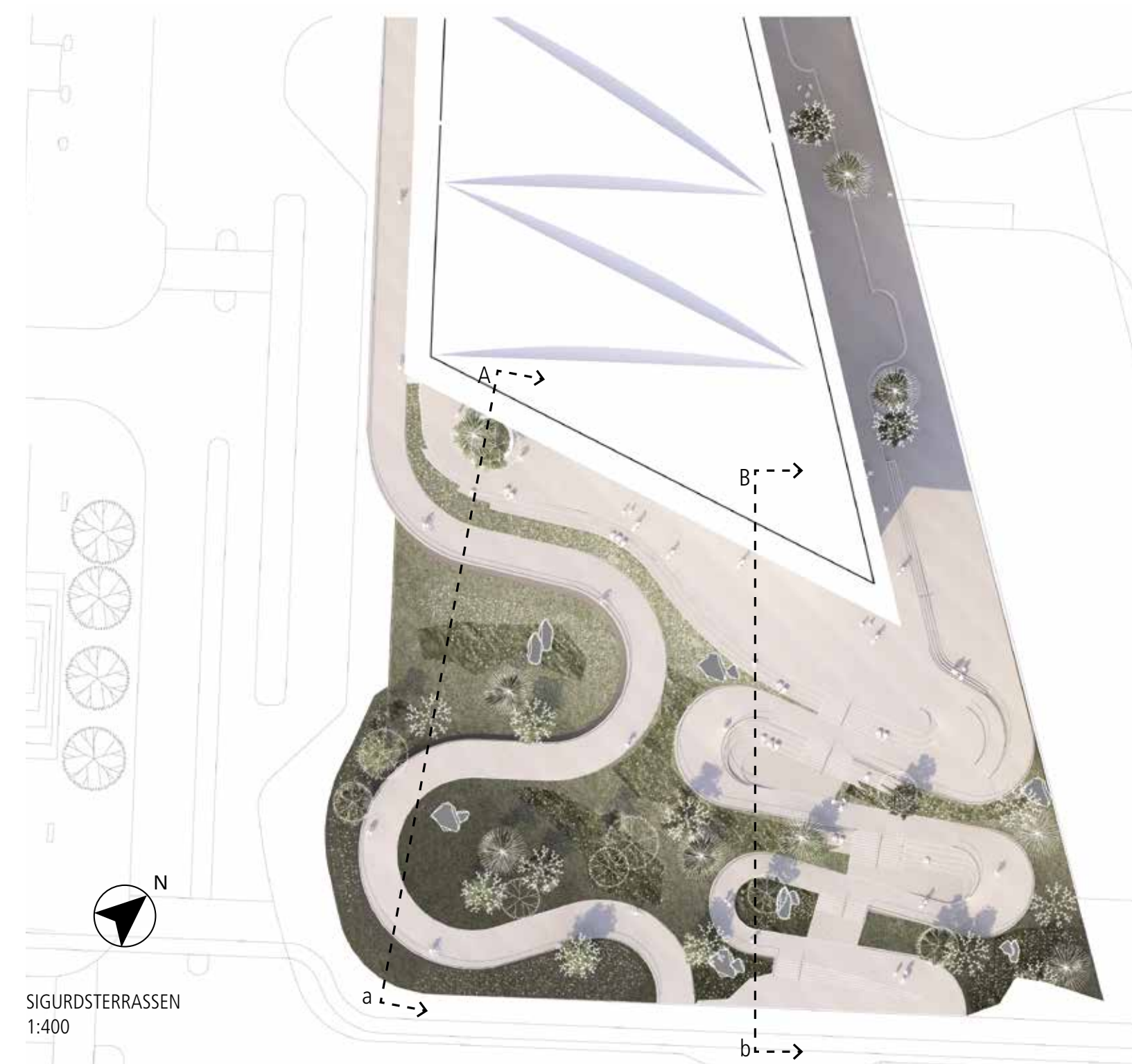
Cykelrampen, den tillgängliga rampen samt platsen framför stationsbyggnaden utförs i platsgjuten betong. Infälld kross markerar skillnad mellan gångytor och platsbildningar samtidigt som det bryter ned skalans och tillför ett taktilt element i beläggningen. Foto: AJ Landskap, Anders Franzéns park.
